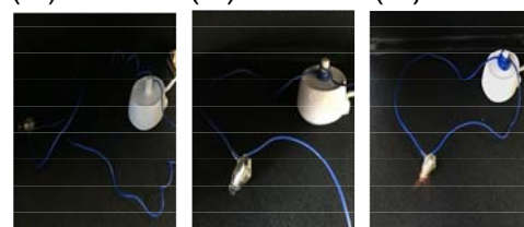
図2 市販の電動歯ブラシ用充電器を用いた際の無接点システムによる豆電球の点灯の様子。ループ導線の巻き数を変えるだけで電位を制御することが可能です。
