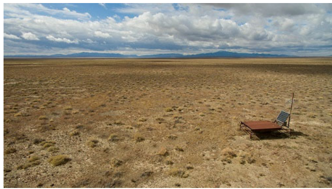
図3：アメリカ ユタに設置されているテレスコープアレイ実験の地表粒子検出器（画像提供：大阪公立大学）
