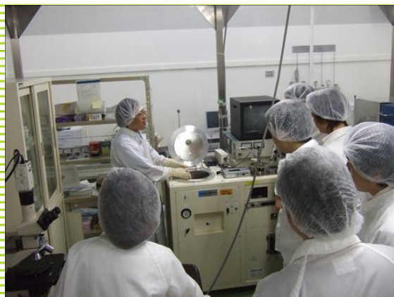
「MEMS実装実習(ウェハ接合技術)」 陽極接合(産業技術総合研究所)
