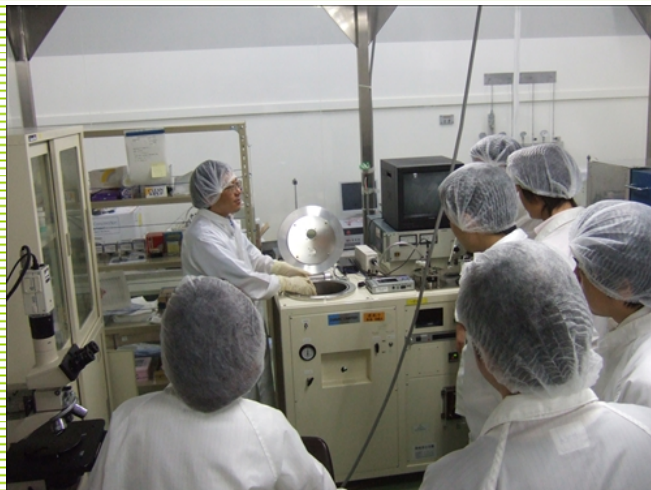
MEMS実装のためのウェハ接合技術「陽極接合」 (産業技術総合研究所)
