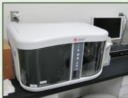
精密粒度分布測定装置「Beckman Multisizer 4」 信州大学松本キャンパス
