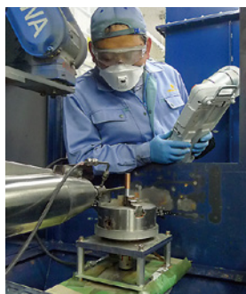
アルミニウム合金の丸棒に銅皮膜を形成した様子。円筒形(ステンレス)のものがコールドスプレー装置のスプレーガン。画面中央の棒(上が茶色、下がシルバー)が、コールドスプレーで銅皮膜を形成した試験体
