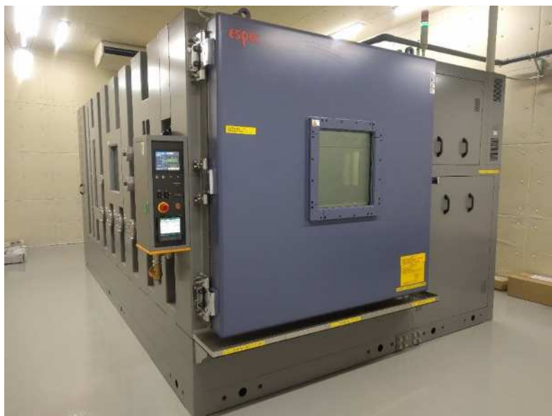
温度・高度・湿度耐候性着氷試験装置 (内寸 = W:1,500mm × H:1,500mm × D:4,000mm) (公財) 南信州・飯田産業センター設置
