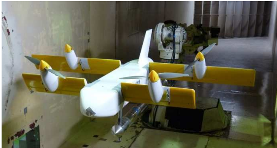
風洞実験中のQTW, 提供JAXA
