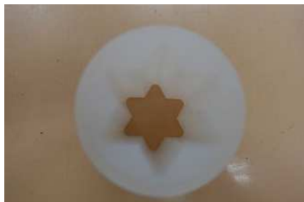
推力向上を目的とした固体燃料の比表面積の増加（内径形状を星形加工）
