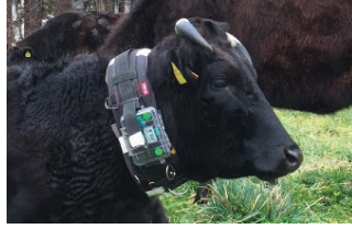
AI処理を搭載した行動センサ(放し飼いで用)
