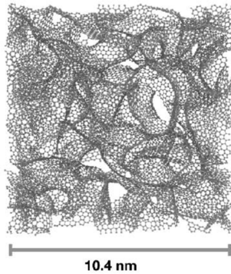
図 4 カーバイド由来カーボン (CDC) の構造モデル
