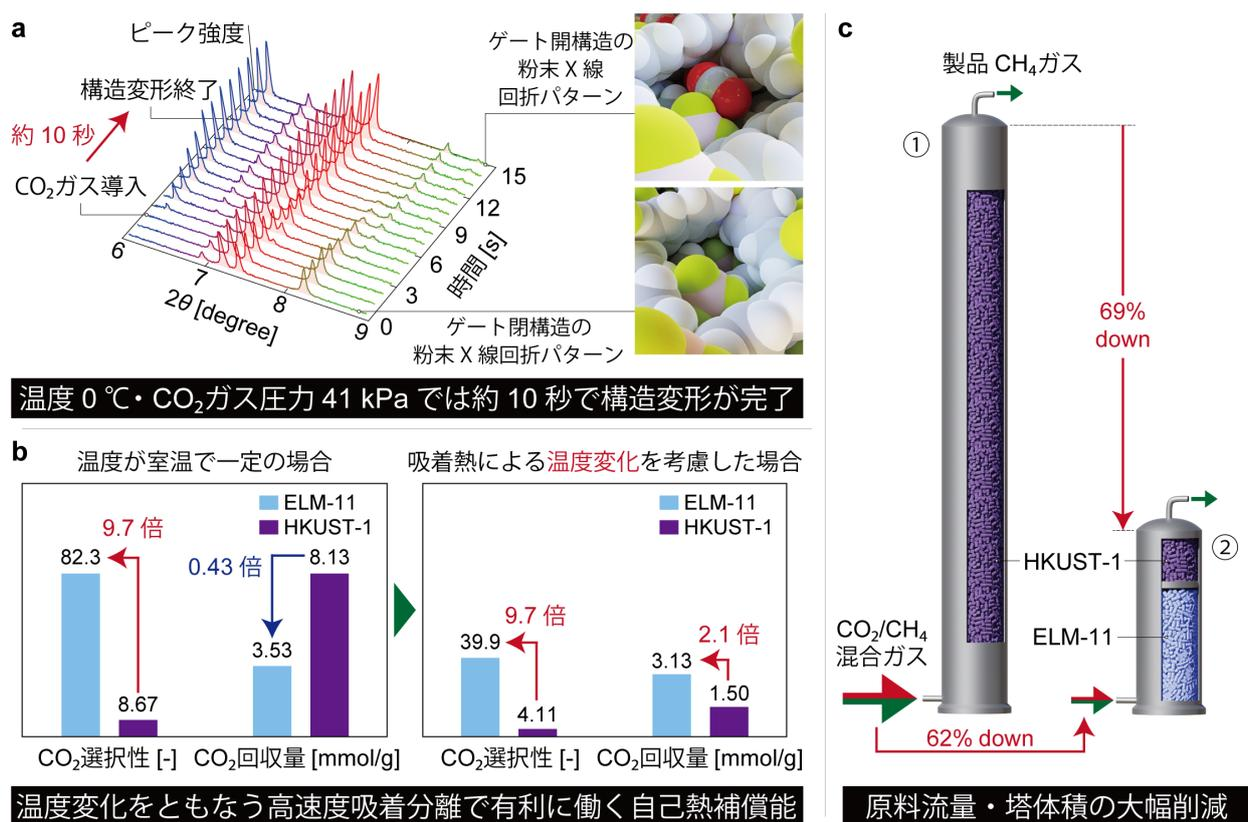
温度 0 °C・CO<sub>2</sub> ガス圧力 41 kPa では約 10 秒で構造変形が完了
