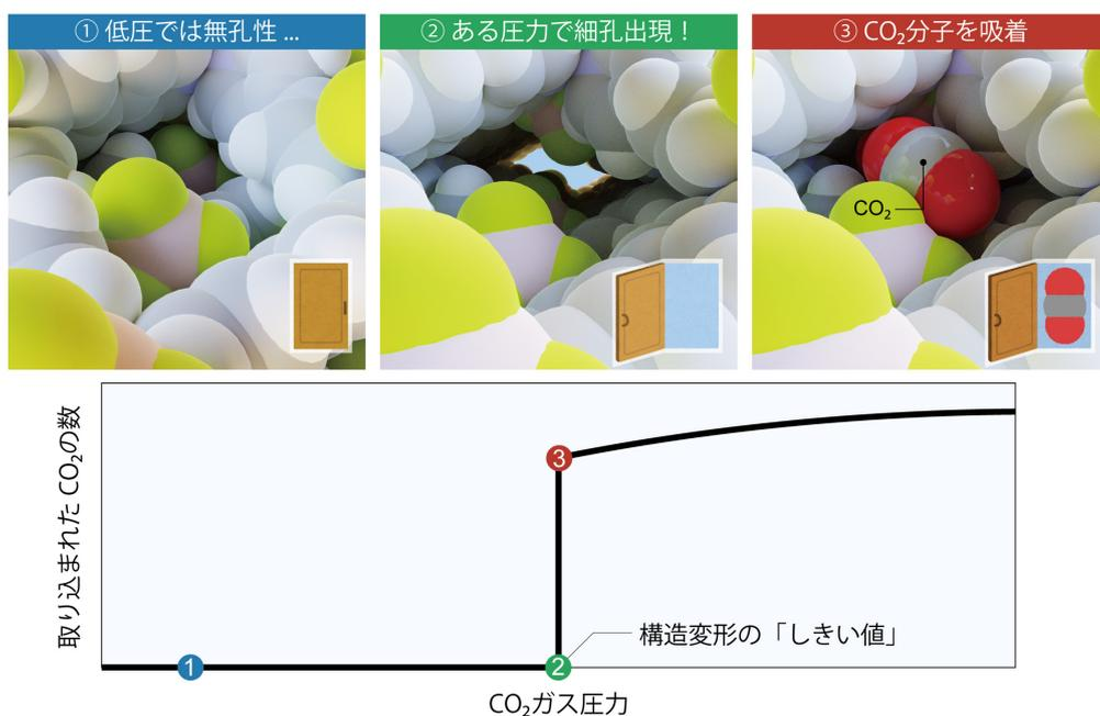
図1 ELM-11(ゲート型吸着剤)のCO<sub>2</sub>吸着挙動
