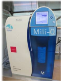
純水製造装置
