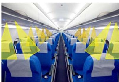
図 15 航空機キャビン内可視光通信システムのイメージ
