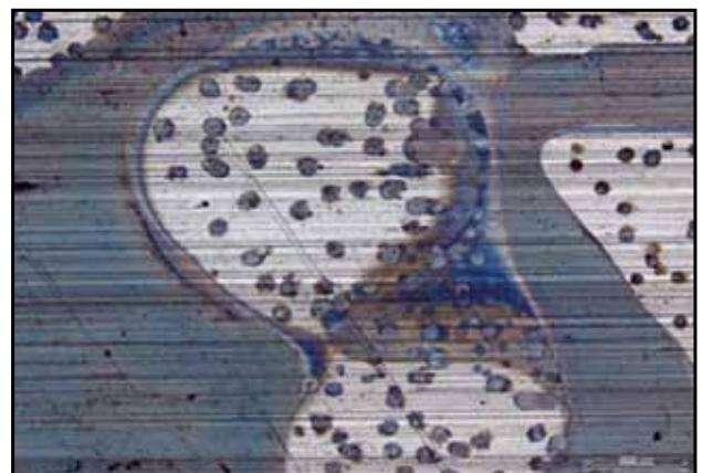
図2 すきま内表面に観察された斑点状腐食
