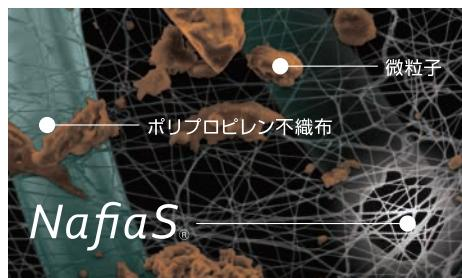
アエルマスクは内側に“微粒子より小さく空気より大きいメッシュ構造のフィルター”NafiaS®を採用しています。空気中の微粒子はフィルターの隙間を通して通過することができないため、体内に取り込む空気をクリーンに出来ます。
