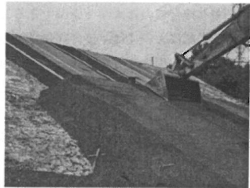
図-10 斜面安定性実証実験の状況
