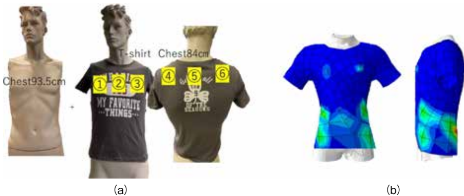
図12 (a) マネキンにTシャツを着用時の衣服圧測定位置 (b) 衣服圧シミュレーション
