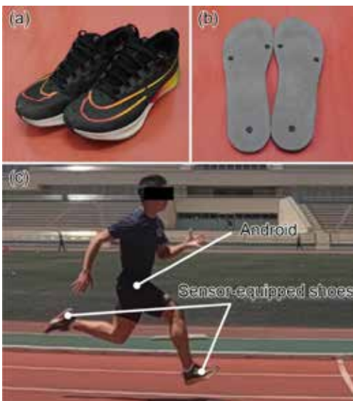
図1 (a) 使用したシューズ (b) MEMS六軸触覚センサ搭載インソール (c) 実験の様子
