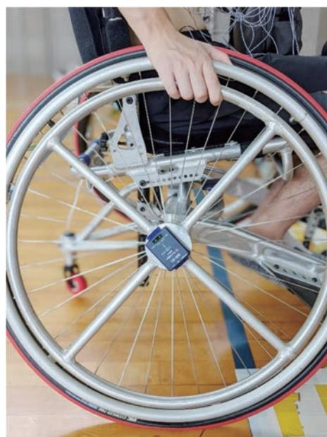
図2 ダブルリング方式のハンドリム
