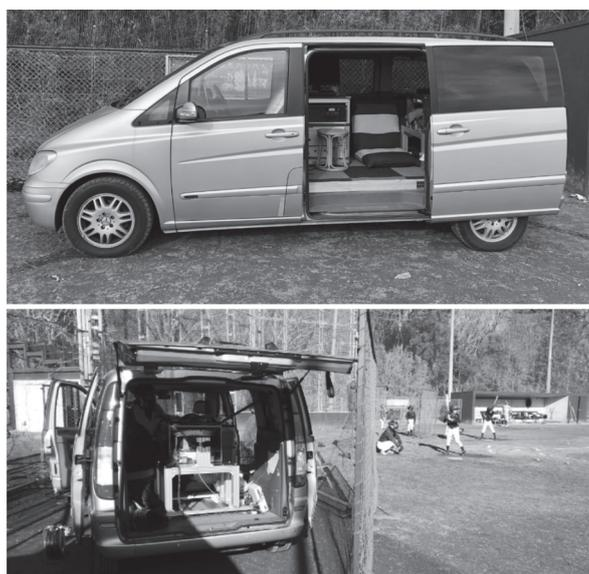
図2 (2枚組) 超小型車載型MRI検診車
