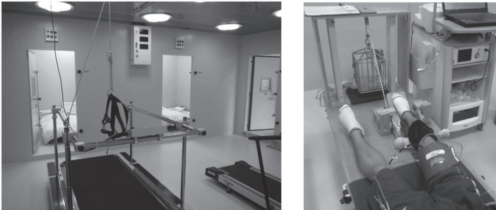
図1 低酸素室(左)と研究用に作成した 仰臥位足関節底屈運動装置(右)
