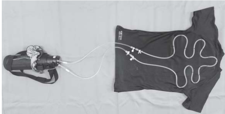
図3 実際に作製、使用した冷却衣服の構成（毛管式）
