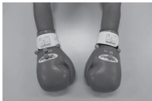
図1 計測用反射マーカと加速度センサの装着方法
