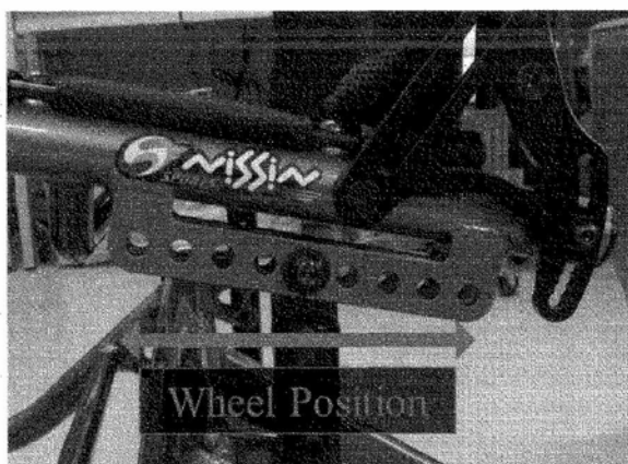
図10 車椅子座面前出し機構
