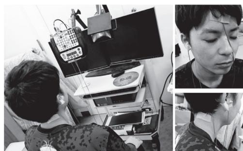
図 4 脳波計及び電極装着状況
