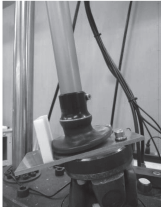
図 4-2 耐久試験時の手先具の様子
