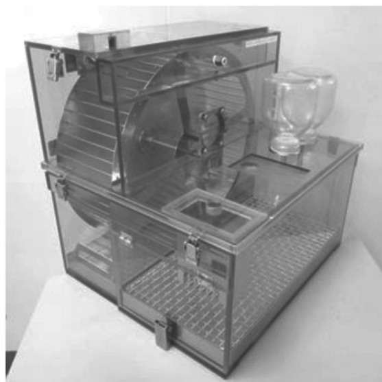
図2 回転かご付き自発運動・エネルギー代謝測定用飼育チャンバー
