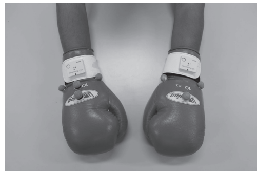
図1 計測用反射マーカと加速度センサの装着方法 計測用反射マーカは左拳に3個，右拳に4個両面テープを用いて装着した。加速度センサは両面テープを用いて手首外側に装着の後，ビニールテープを用いて固定した。(この図はビニールテープで固定する前の状態。)
