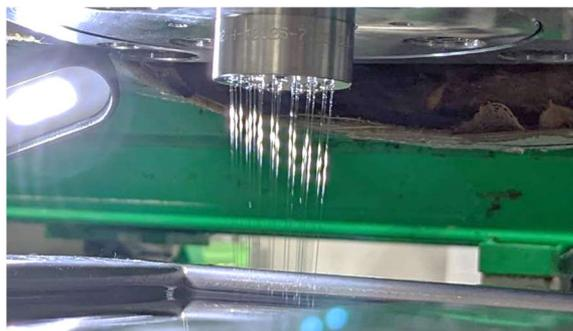
乾湿式紡糸によりポリマー溶液を作製している様子
