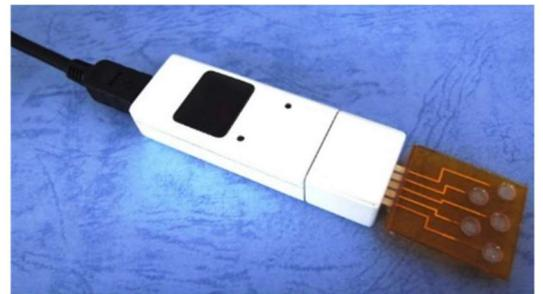
ポータブル味覚センサ。プラスチック基板電極に複数の脂質高分子膜電極を搭載させたマルチチャンネル型センサ
