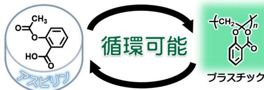
頭痛薬と知られるアセチルサリチル酸（アスピリン）を原料に、分解・再合成による資源循環（ケミカルリサイクル）が容易なプラスチックを開発。資源循環を目的に設計されたビニルポリマー（炭素-炭素結合で連結された高分子）としては、世界初の例です。
