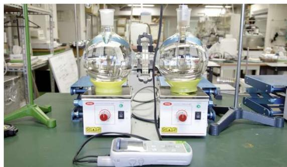
左が塩水、右が真水で、間にあるフィルムを通して塩分がどれだけ真水側に移動するのかを、塩分濃度計で測定する
