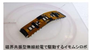
磁界共振型無線給電で駆動するイモムシロボット
