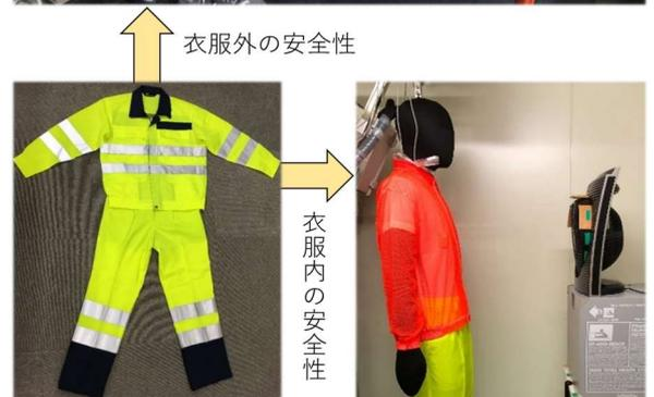
高視認性安全服に用いられる蛍光生地での光反射測定(上段右図)
