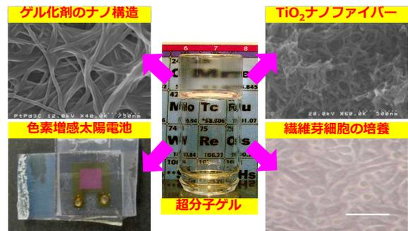
低分子ゲル化剤が超分子ゲル中で形成するナノ構造、色素増感太陽電池のゲル電解質、TiO<sub>2</sub>の鋳型作製、細胞培養基材への応用
