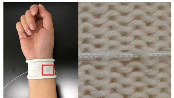
左：試作したリストバンド型マルチバイタルサインセンサ、右：FBGセンサの繊維製品への導入（左図赤部の拡大図）
