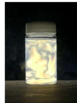
左は植物中のセルロースウィスカー。ナノサイズのファイバーは鋼鉄よりも強い弾性率を持つ。さらに偏光板の間で光る液晶にもなる。
