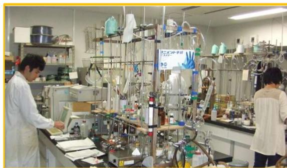
実験室風景。様々な試薬や溶媒、ガラス器具を使い目的とする有機化合物を合成していく。生成物の構造はNMRなどで確認する
