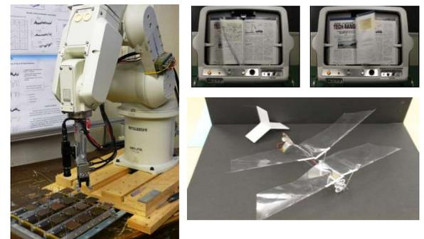
ロボットによる金属板ハンドリング(左)、人の手と同じ原理のページめくり機(右上)、トンボを手本とした羽ばたきロボット(右下)
