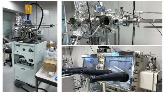
金属溶解炉(左)、単結晶薄膜合成装置(右上)、非酸化雰囲気操作装置(右下) 試料の合成、取り扱い、触媒評価の全てを精密に行い、メカニズムを解明!
