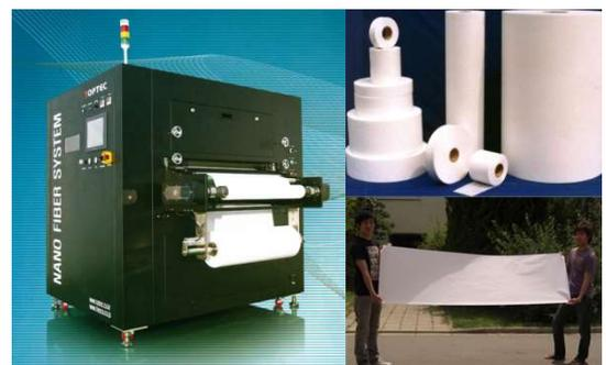
世界で初めて開発に成功したパイロット式ナノファイバー量産機(左図) 作製したナノファイバー不織布(右図)
