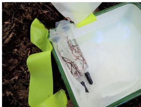
図2. 調査地における吸収測定の様子。掘り出した細根を窒素溶液が入った容器に浸し、90分間静置した。
