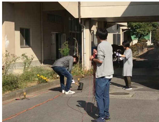
写真1 表面波探査法による調査
