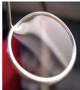
磁場内で作成した高分子の薄膜。直径 20 mm。通常の重力下では、この大きさの膜は割れてしまう。
