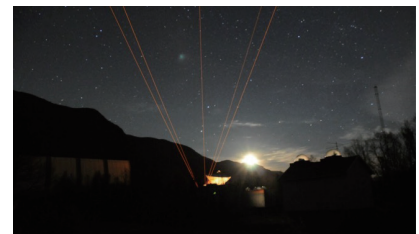
最低気温が-20℃にもなる冬季のEISCATレーダー観測所から、宇宙に向けて射出される黄色のレーザ。オーロラ活動時の大気温度の空間変動を調べるため、5方向に射出。
