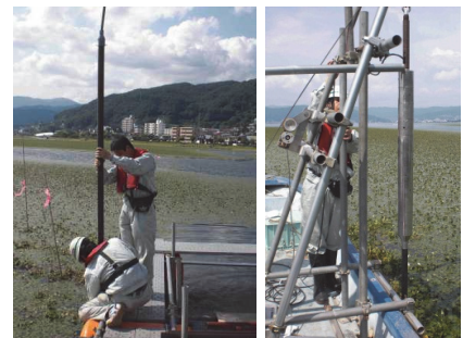
閉鎖性水域(諏訪湖)における底泥のサンプリングと湖底地盤の強度調査および密度検層
