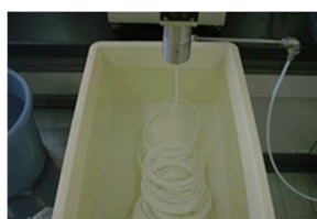
非溶媒相分離法による中空糸膜の作製プロセス
