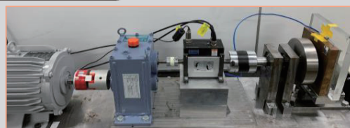
航空機用次世代ブレーキに向けた渦電流ブレーキの研究の実験装置
