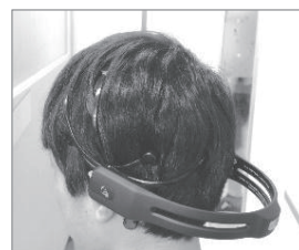
簡易型脳波計 ヘッドセット型の脳波計測ユニットで装着が容易でワイヤレス計測が可能、インタフェースなどへの応用実験を実施中
