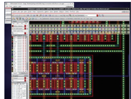
図2 集積回路設計の様子。アプリケーションに応じて、仕様を決め、回路図を作成し、それに対応した数十nm精度の配線レイアウトをCADソフト上で描き、半導体チップを設計、試作する
