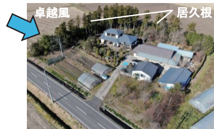
宮城県北部に位置する大崎耕土の農村住居。 冬の卓越風側に伝統的な屋敷林「居久根」があることで、住宅や中庭を強風から守る仕組み。
