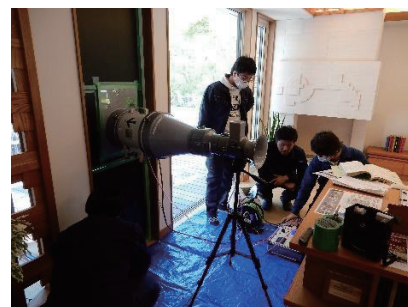
高断熱・高気密住宅の気密性能値を明らかにするための実測の様子
