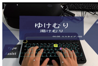
複合現実を用いたタイピング学習を支援するシステム。次に押すべきキー、使用する指などの情報を現実のキーボードや指の上に表示することができる
