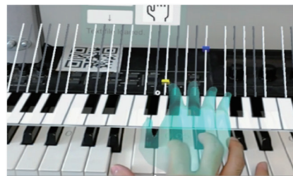
ピアノの演奏時に、次に弾くべき鍵盤の位置、使用する指などの情報を複合現実で可視化したシステムである
