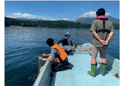
野尻湖はいつ来ても風光明媚でいいところ。 湖心にロガーを設置して湖心で溶存酸素の濃度と水温を5分おきに計測しています。
