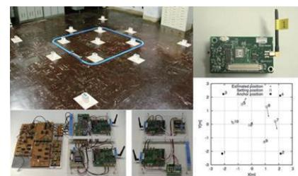
無線センサネットワークのための末端位置計測実験の様子。センサ末端間の無線通信情報のみを利用して、末端の位置推定を実現する技術の構築を試みている
