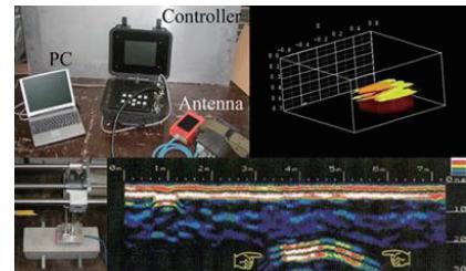
マイクロ波レーダ装置とレーダ画像(内部断面画像)の例。計測精度をさらに高め、誰もが簡単に構造物の内部情報を詳細に把握できる技術とすることが目標である
