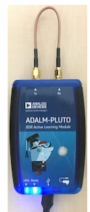
左：ADALM-PLUTOを用いて生成したOFDM信号波形 右：ANALOG DEVICES社のソフトウェア無線機 ADALM-PLUTO
