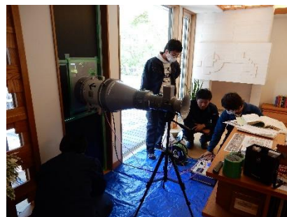
高断熱・高気密住宅の気密性能値の実測
