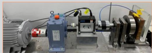
航空機用次世代ブレイキに向けた渦電流ブレイキの研究の実験装置
