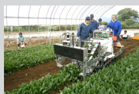
開発したほうれん草自動収穫装置による圃場試験の様子（2015）
