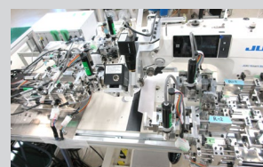
布のハンドリングと自動縫製技術の開発を目的とした実験装置（2022）
