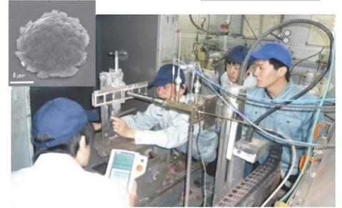
研究室で作製したコールドスプレー装置で実験をする様子です。
