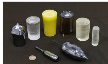
当研究室および共同研究企業で育成した機能性単結晶の写真。シリコンなどの半導体単結晶、サファイアなどの酸化物単結晶育成を実現している。
