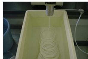
非溶媒相分離法による中空糸膜の作製プロセス
