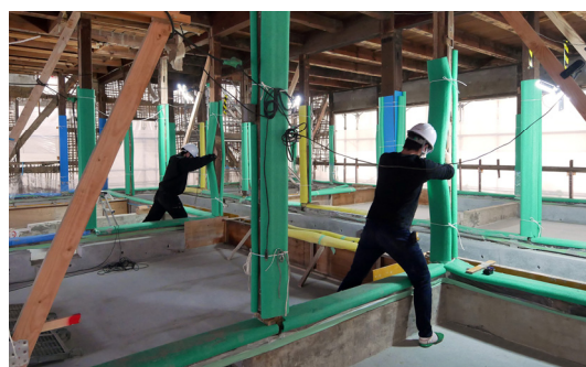
実際の建物を対象とした振動実験
